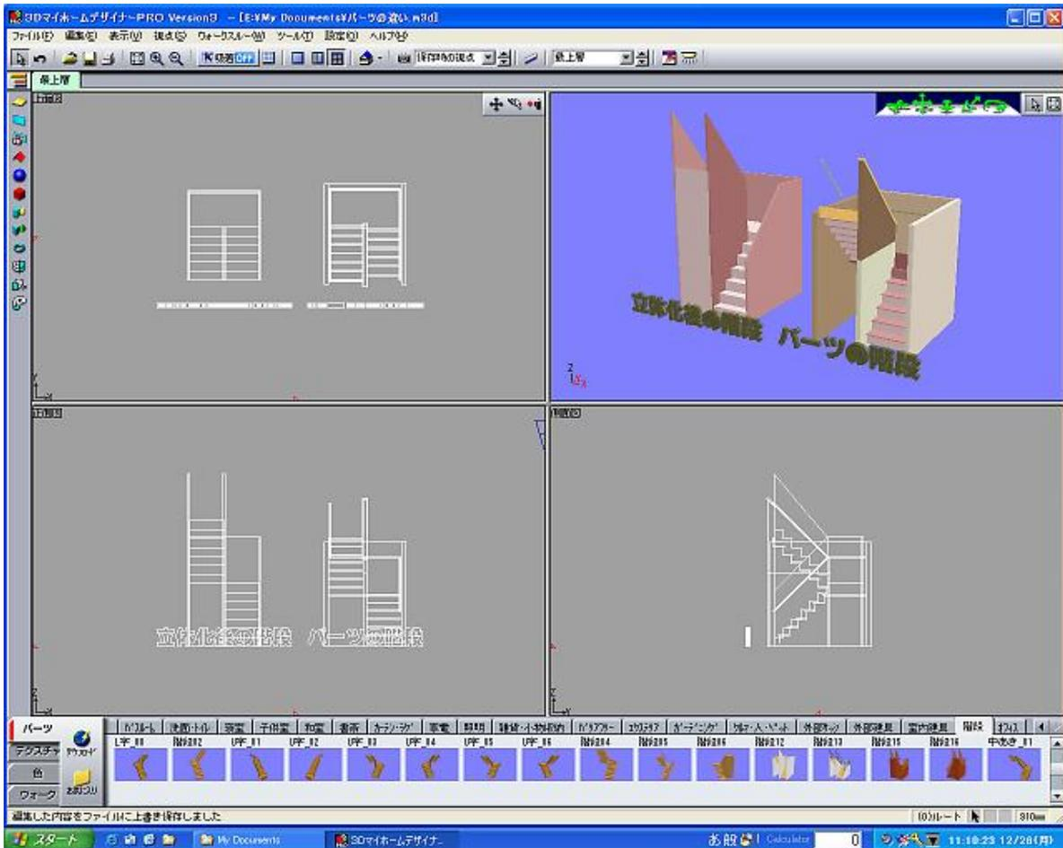
次頁のように【ツール】→【パーツ階層図】でパーツの階層状況を見ることができですが『**立体化後の階段**』は3個のパーツで構成されています。
